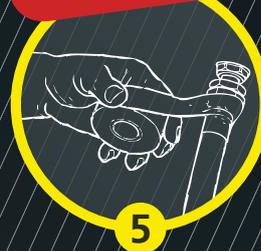
5 Tester l'installation et protéger la partie dénudée avec de la bande auto-adhésive
